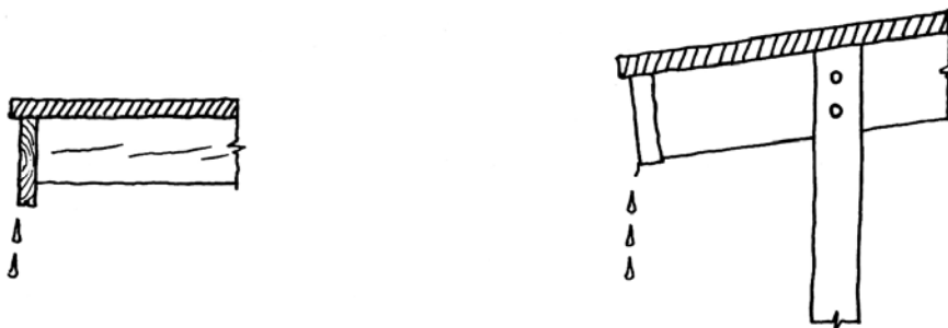
Figura 4.20 Protección de las testas de las piezas voladas: izquierda) Tabla en la testa para evitar la absorción de agua y derecha) Protección de la testa mediante un forro de chapa metálica.
