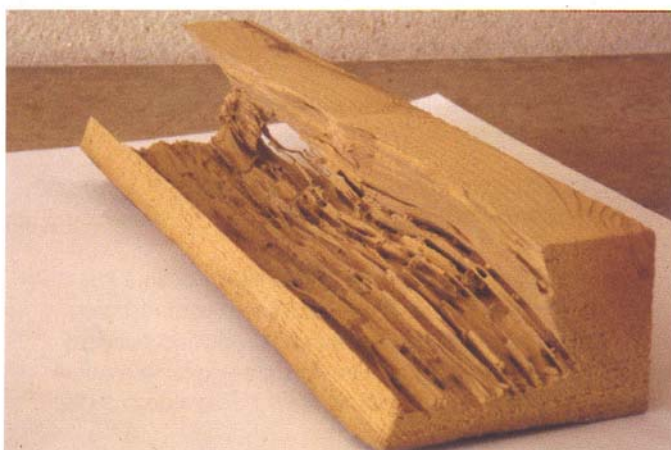
Figura 1.5 Daños producidos por termitas.
