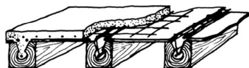
Figura 6.45. Sistema de hormigón armado y ahuecado de las vigas.
