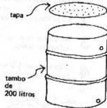
Después de algún tiempo de uso se necesita sacar las impurezas que quedaron sedimentadas en la arena, habrá que cerrar la llave de agua y sacar el tapón. El agua dentro del tambo sale y limpia la arena llevando las impurezas. Después se tapaná de nuevo y abrirá la "llave" para continuar la circulación del agua.
