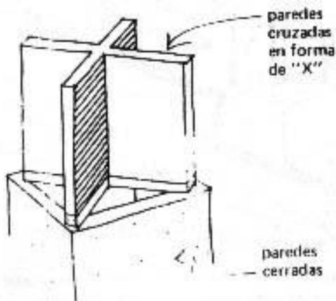
Al mismo tiempo se levantan las paredes exteriores con sus aberturas.
