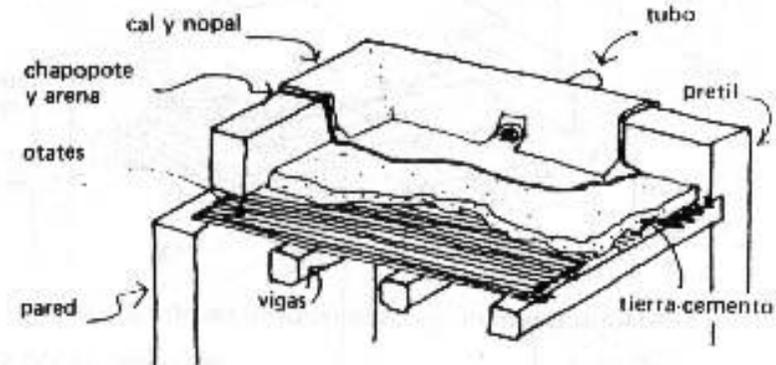
El acabado final con chapopote y arena se pone sobre la parte superior de la capa, puliéndola con una mezcla de cemento. Después se pinta el acabado con una mezcla de cal y nopal para que la superficie final sea de un color claro que refleje los rayos solares.
