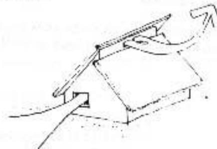
Bajando un lado del techo se obtiene una mejor ventilación. El aire caliente sube y sale por la ventana de arriba, mientras el aire más fresco entra por la ventana de abajo.
