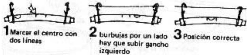
Ejemplo: Para ver a qué altura se debe levantar el otro muro para que esté al mismo nivel que el ya hecho, se tensa bien un hilo y se cuelga su nivel. Cuando la burbuja está en el centro se mide la altura. Ahora se sabe cuántos centímetros faltan para levantar el nuevo muro.
