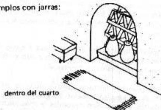
El dibujo muestra la colocación de dos jarras sobre el repizón que forma parte de la abertura. Como el agua pasa muy lentamente por las paredes de las jarras, se pone un plato abajo para recoger el agua filtrada.
