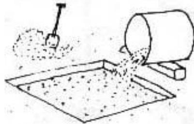
**3** Hacer una excavación poco profunda. Echar el agua de nopal y después agregar cal viva. Se usa 1 tambor de líquido por cada 2 tambors de cal.
