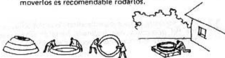
Antes de colocar el siguiente anillo hay que poner lodos sobre el anillo anterior para que los anillos se peguen. Adentro se da un revestimiento con lodo para que quede bien liso.
