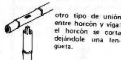
otro tipo de unión entre horcón y viga: el horcón se corta dejándole una lengüeta.
