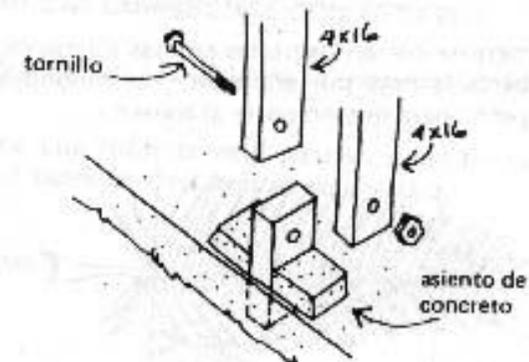
Una cimentación continua debe tener bloques enterrados para conectar las columnas. Además hay que poner bases de concreto para que la madera no se pudra. El bloque tiene también 4 x 16 y debe ser pintado con aceite quemado u otro tipo de protección. Ver capítulo 2.
