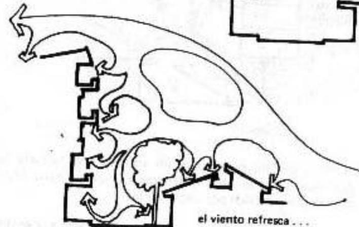
El viento tiene que dar muchas vueltas, refrescando las fachadas y techos. Esto se consigue, construyendo balcones y techos con inclinaciones.
