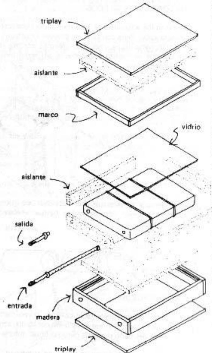
las partes de un calentador de 40 litros
