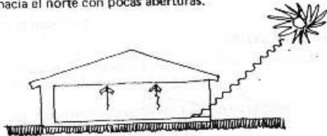
El sol puede calentar los cuartos cuando entra por las ventanas que dan a la fachada sur. El muro aislante impide que se pierda este calor rápidamente.
