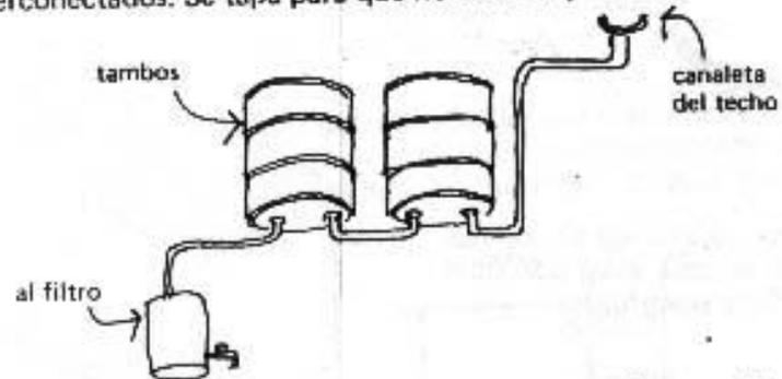
Los tanques deberán ser colocados abajo del techo y arriba de las áreas de uso, como cocina y baño. De esta manera no será necesario instalar bombas para subir el agua:
