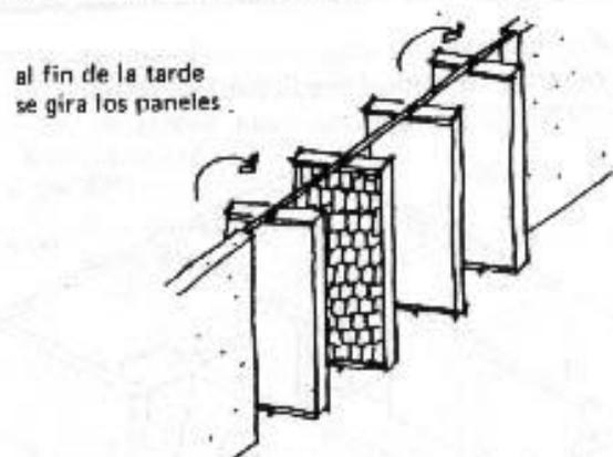
El panel está hecho de tela gallinero con una placa de triplay, tablas de madera. Sobre un estante abajo se coloca una hilada de latas conteniendo agua, pintadas por afuera del color negro mate. Y se las fija con alambre. Así se hacen hiladas hasta arriba. El panel mismo puede ser pintado de cualquier color.
