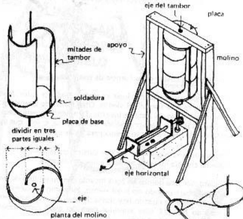
Existen varias maneras de utilizar el movimiento del eje del molino. El dibujo más grande muestra el uso de un cambio de engranes, mientras el dibujo de a lado tiene otro cambio, usando una banda de cuero, para mover el eje horizontal.
