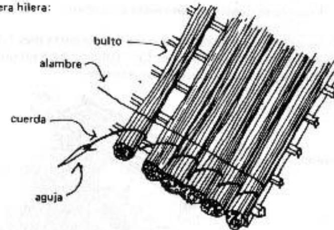
La parte baja de la siguiente hilera cubre el alambre y la cuerda de las primeras hileras de bultos abajo.
