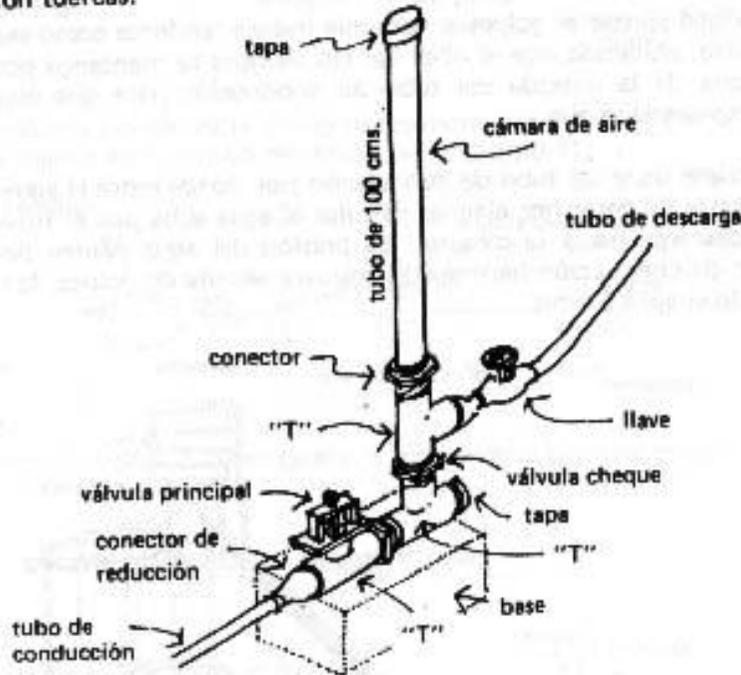
Hay que montar bien firme toda la bomba ariete sobre una base de madera o de concreto para soportar los movimientos del agua.
