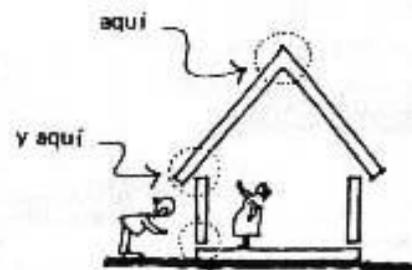
Igualmente, las fallas de construcción, a través de los efectos de viento, lluvia o temblores, frecuentemente empiezan a ser notorios en estos puntos.
