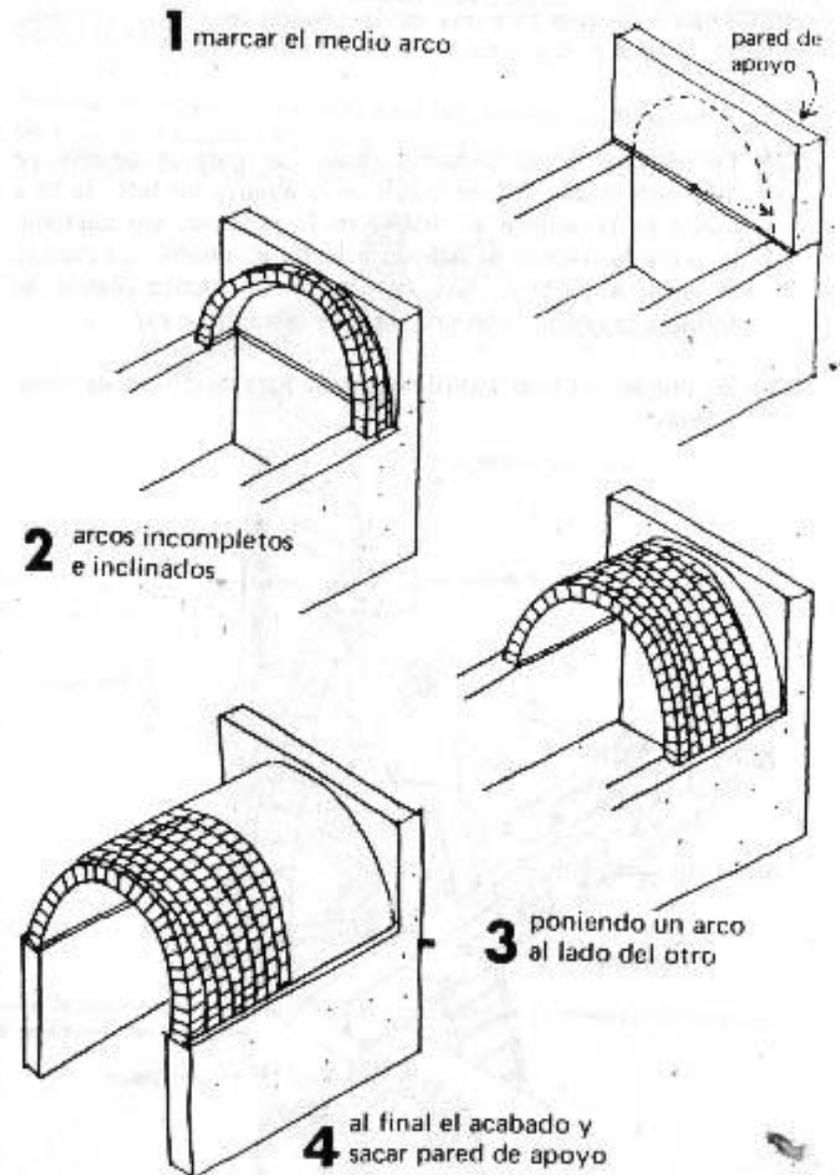
Terminada la bóveda, se puede quitar la pared de apoyo y llenar la abertura con ladrillos o se puede poner una ventana.
