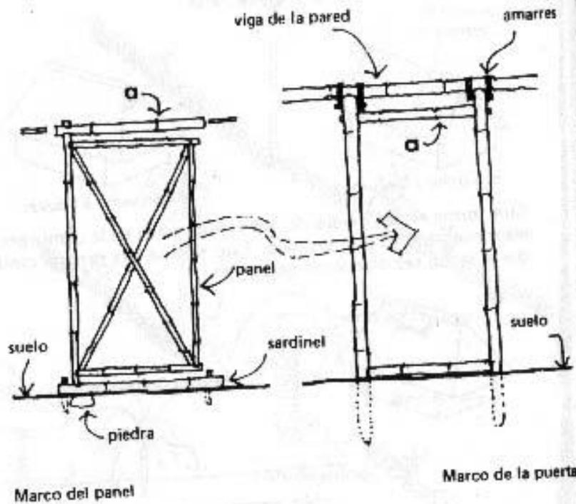
La pieza (a) del marco es la misma en los dos dibujos, tienen dos lengüetas para fijarse al marco de la puerta. El sardinel se fija clavándolo al suelo o con lengüetas al marco. El panel está cubierto con petates de bambú tejido y gira sobre una piedra colocada abajo del sardinel.
