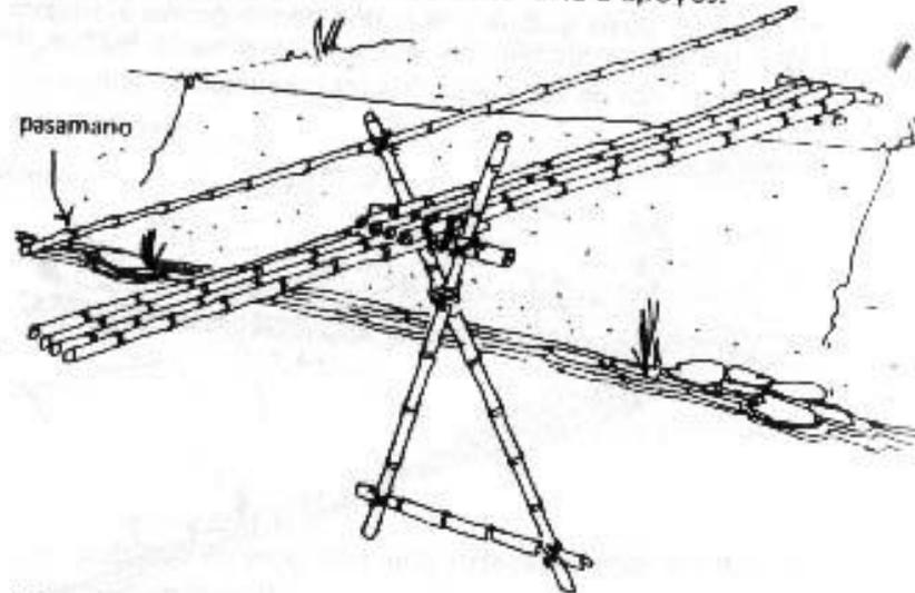
Vista parcial de un puente liviano sobre un río ancho. Un puente pesado tendrá más apoyos en su estructura como se muestra abajo:
