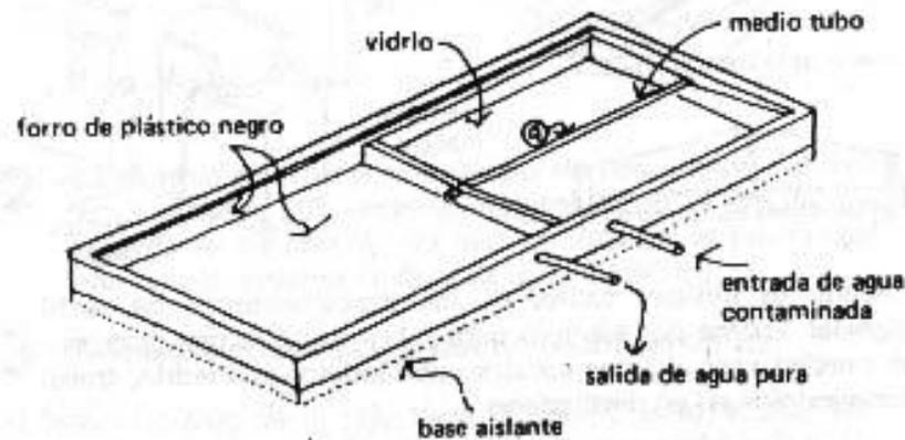
Un lado de la caja deberá tener un medio tubo para captar las gotas de agua que caigan del vidrio. El vidrio deberá cubrir la caja de dos piezas inclinadas en el centro, apoyadas las dos piezas de vidrio en una "T" invertida de hierro.
