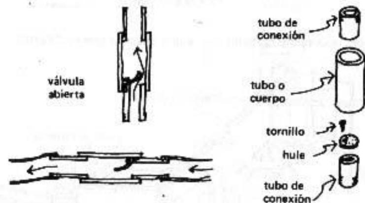
Una válvula de chequeo "chec" sólo deja pasar el agua en una sola dirección.
