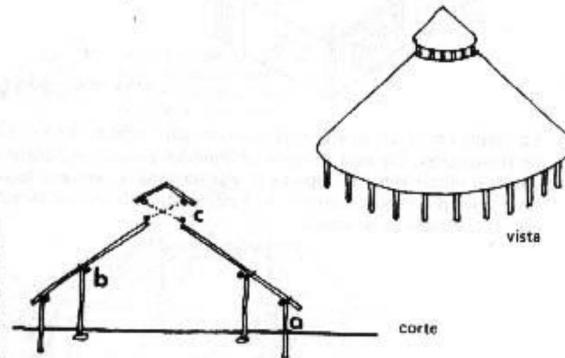
Una estructura más elaborada: los horcones (a), son enterrados y deben estar bien amarrados a las vigas del techo, las vigas se apoyan sobre los postes (b). Arriba hay un anillo de ramas juntas y atadas con refuerzos diagonales (c). Arriba del anillo existe otro techo. Los puntos son vigas-anillos.
