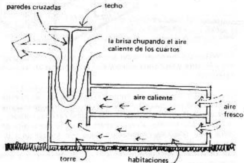
Con el viento entrando por un lado y saliendo por otro de la torre el aire caliente de los cuartos es succionado hacia la torre, provocando que aire fresco entre por las ventanas.
