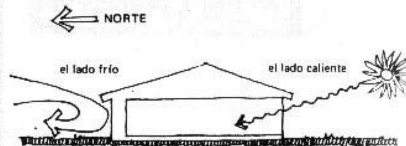
Tomando entonces en cuenta los efectos de la orientación, hay que tener cuidado de que el calor por el lado sur no se pierda por el lado norte. Al mismo tiempo hay que evitar que el calor no escape por el techo, ya que el aire caliente tiende a subir. Se debe construir un techo o plafón aislante y una pared hacia el norte con pocas aberturas.
