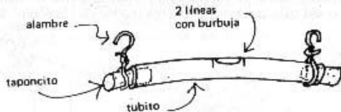
Llenar con agua y se coloca otro taponcito, de tal manera que quede una burbuja de aire. Hacer otro gancho, pero fijo sólo en la tapa, para que se pueda arreglar la burbuja después. Hay que poner una poca de cera en las tapas para evitar que el agua pase la madera.
