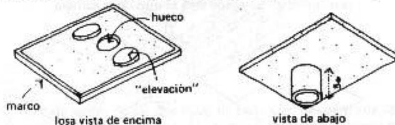
El tubo se entierra con el collar saliendo, el cemento se mete de tal forma que se pega al collar. Para no ensuciarse los pies, se dejan dos elevaciones a los lados del hueco.
