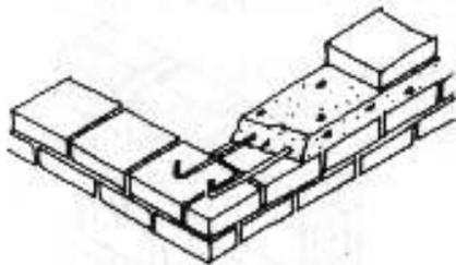
Un ángulo hecho de concreto con dos partes de varillas que enganchen a la esquina.
