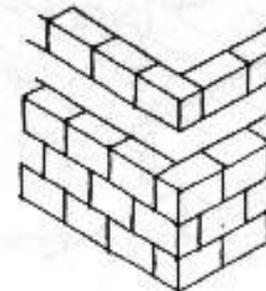
Se recomienda reforzar las esquinas de los muros de adobe, con ladrillos de barro cocido para evitar cantos quebrados.
