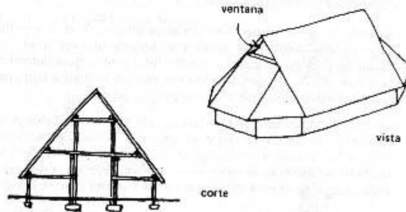
Una forma de estructura que necesita troncos bastante largos. La parte central es más alta y a los lados se construye un entrepiso o galería elevada, los techos laterales deben ser colocados más bajos para tener una ventana triangular grande para iluminar el centro.
