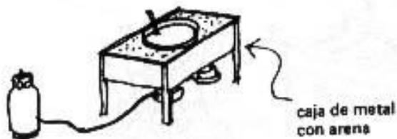
Cuando se forma el líquido hay que añadir un plastificante en pequeña cantidad —una parte de plastificante por 50 de azufre—. Un buen plastificante es el aceite vegetal. El azufre es quebradizo, por esto hay que mezclar con plastificante. Hay que probar hasta conseguir una buena mezcla.
