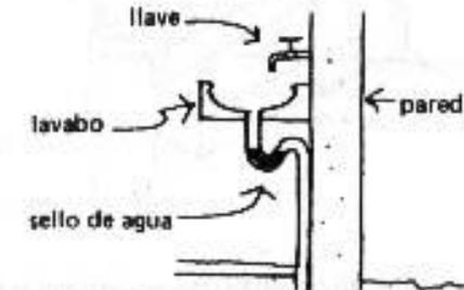
Esta trampa se hace de una pieza de tubo doblado, de tal manera que siempre quede un poco de agua en el codo más bajo, cerrando así el paso de olores.
