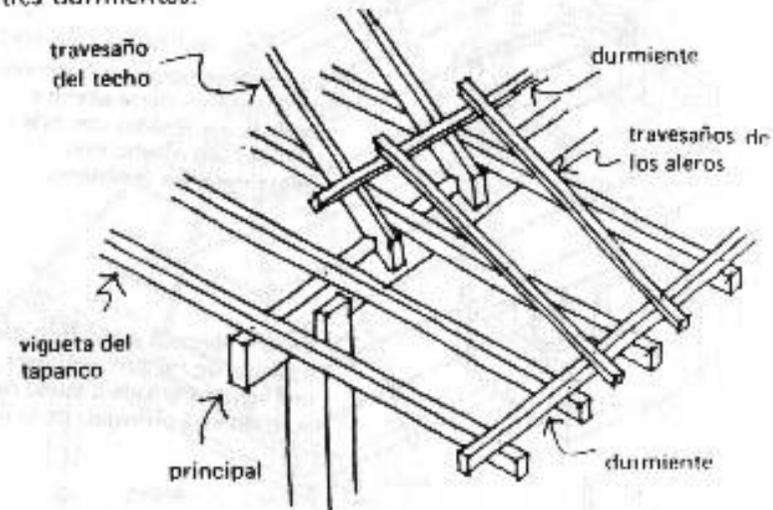
El durmiente debe estar bien fijo sobre las paredes. Se corre el peligro de que si éste se desliza, las vigas del techo se pueden soltar y la estructura podría caer.
