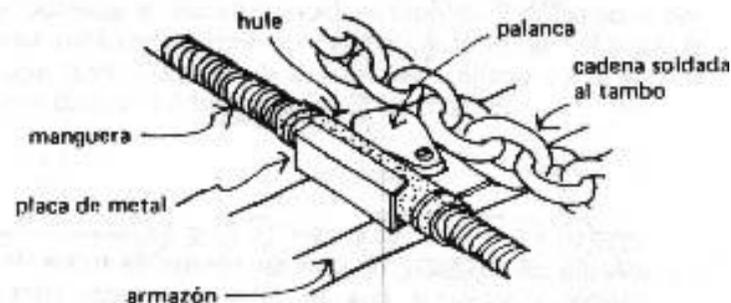
Se monta el armazón con el molino-tambo entre el pozo y la cisterna:
