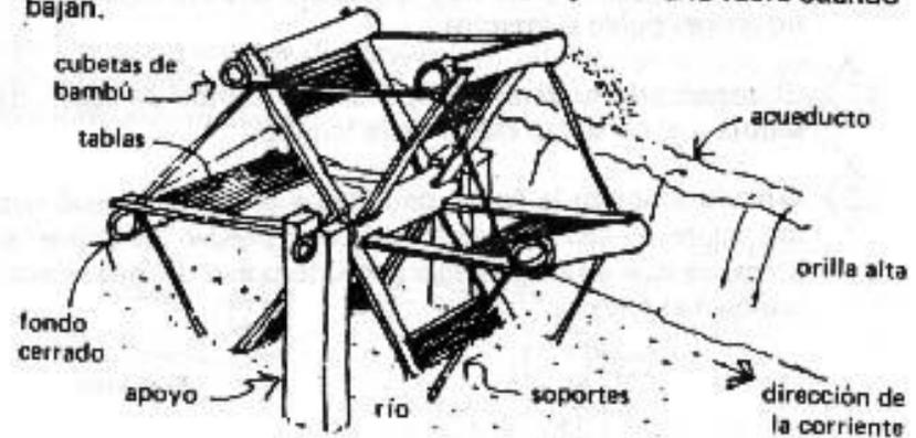
Los extremos de los soportes se amarran entre sí con tiras de bambú y bejuco para dar más fuerza a la estructura de molino. Luego, junto al tubo se fija una tabla entre los soportes, para que la corriente del río haga girar al molino.
