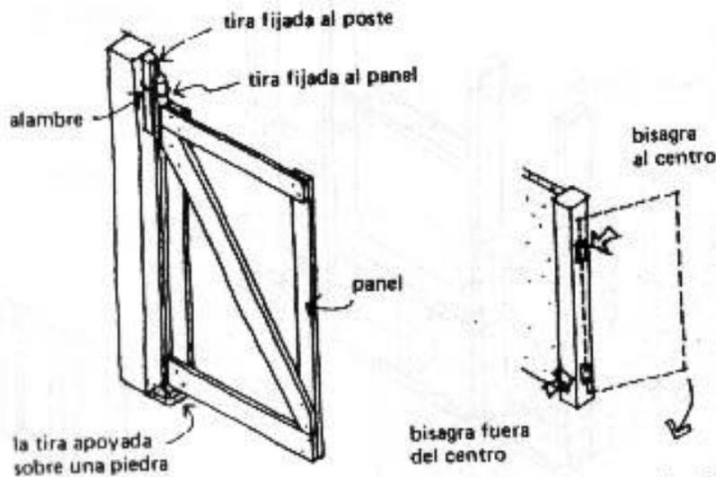
Nota: Cuando se coloca la bisagra de arriba un poco hacia adentro sobre el marco -fuera de plomo- la puerta se cierra por su propio peso.
