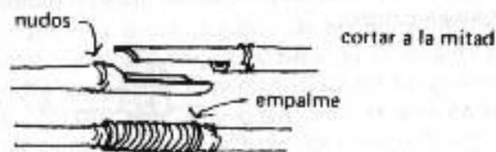
Arriba se muestra una junta o unión, cuando no se va a tener presión o peso encima.
