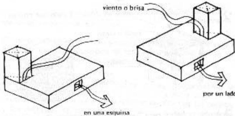
Este tipo de captador de aire se puede localizar en cualquier parte del techo, siempre viendo que el aire pase por las habitaciones más usadas o más calientes,
