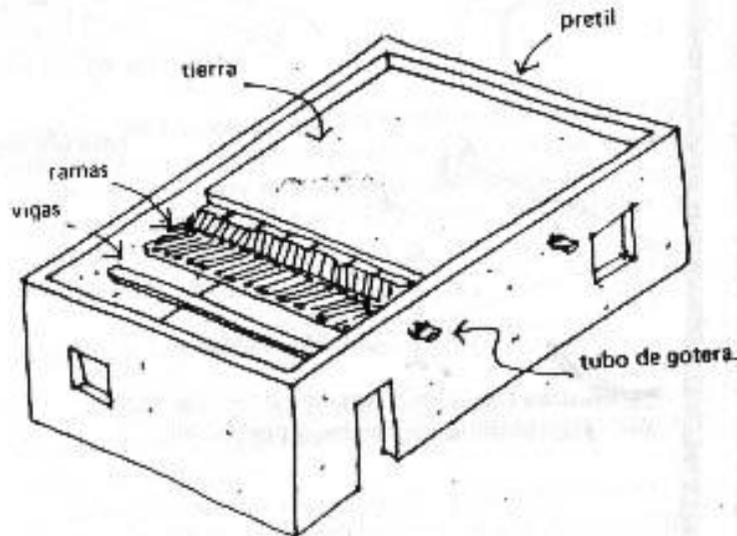
Las vigas tienen una pendiente de 4 cms. por cada metro para que el agua de la lluvia pueda correr hacia algunas salidas con tubos.
