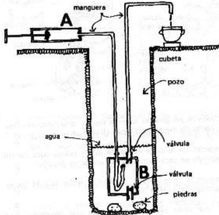
El aparato consiste en dos partes: una bombita A y una lata B con una cámara de bicicleta más dos válvulas de chequeo. De la bombita viene una manguera llena de agua que pasa a la lata y termina en una cámara de llanta de bicicleta. De la lata sale otra manguera para subir el agua del pozo.
