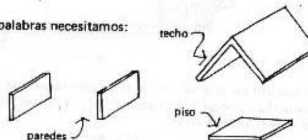
Muchas veces los problemas de mantenimiento de la casa, como filtraciones de agua, insectos, calor o frío excesivo ocurren en primer lugar en las juntas o conexiones de estas partes: techo, piso y paredes.
