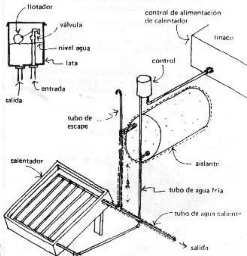
El tubo donde circula el agua más caliente debe estar cubierto con material aislante; también el tubo que va para la red de agua caliente hacia la cocina y el baño. Es necesario un tubo de escape más alto que la válvula de control para que cuando la temperatura del agua suba mucho haya un escape de presión. Se necesita, también, un tubo de escape para controlar la presión.
