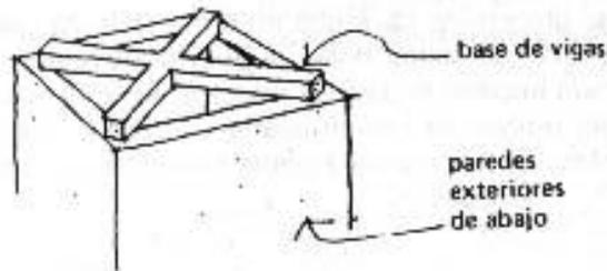
La base de las paredes cruzadas se construyen sobre las paredes exteriores, y son hechas de vigas de madera o de concreto.
