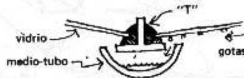
Un corte del detalle (a). Abajo hay un corte de la parte del destilador.
