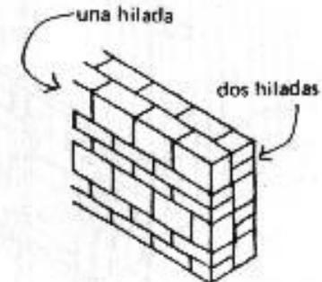
Corte de una pared que muestra un cambio en las hiladas
