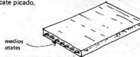
La parte redonda del otate es hacia arriba para que abajo haya mayor adherencia con el lodo.
