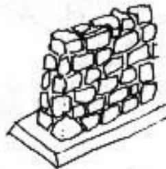
Se deberán alternar las juntas de piedra de una hilada a otra para que la pared no se agriete con los temblores. Por un lado se pone una "crucecita" con dos hilos, para asegurarse que la pared quedará bien recta.
