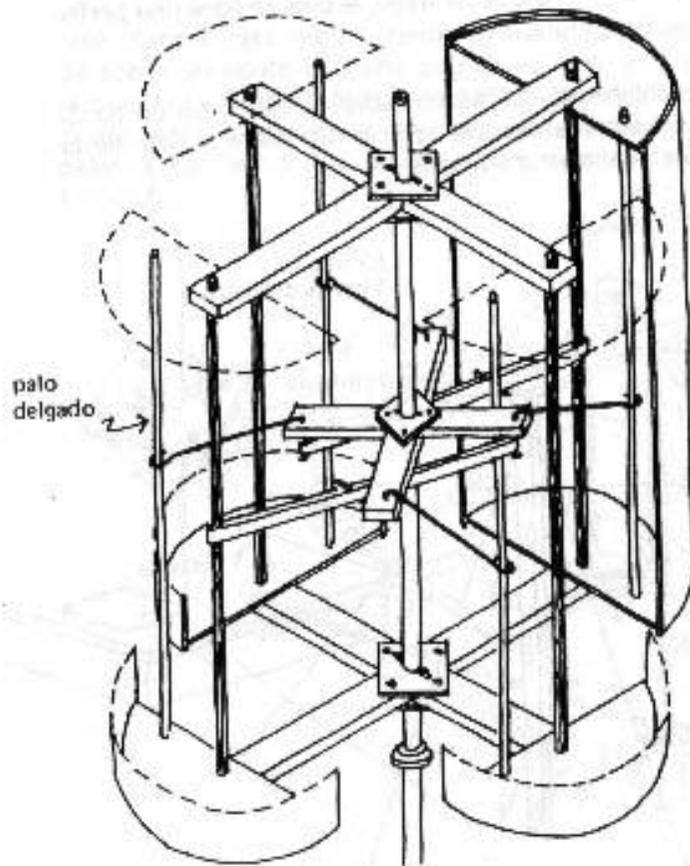
Vista parcial de un aspa de un molino. Se conecta una tercera cruz de bielas con 2 cámaras de bicicletas a los mangos de escoba de los medios tambos (aspas). Se puede regular la fuerza de tensión de las cámaras con un tornillo que, ajustado, se fija a la cámara.
