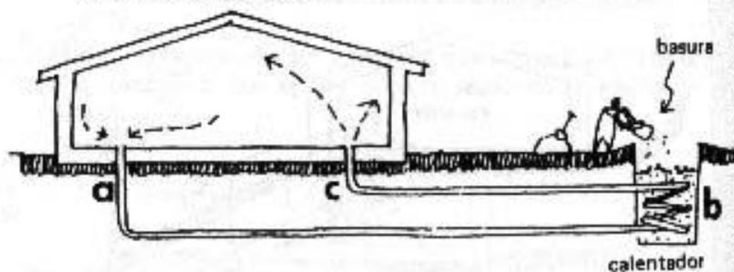
En el hoyo, hay que colocar los tubos en forma espiral para que el aire tenga más contacto con el calor.
