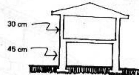
Otra manera de calcular el espesor de la pared es haciéndolo  $\frac{1}{10}$  parte de la altura; como por ejemplo con una pared de 3 metros de altura tendrá un espesor de 30 cms.
