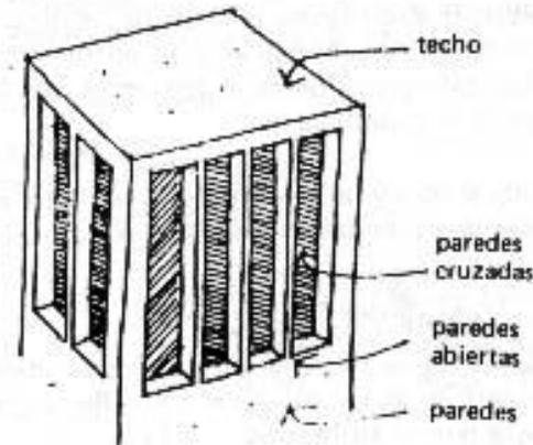
Cuando se utilizan bloques de concreto para la construcción de las paredes de la torre, hay que llenar los vacíos de los bloques con tierra para que se retarde la penetración del calor.
