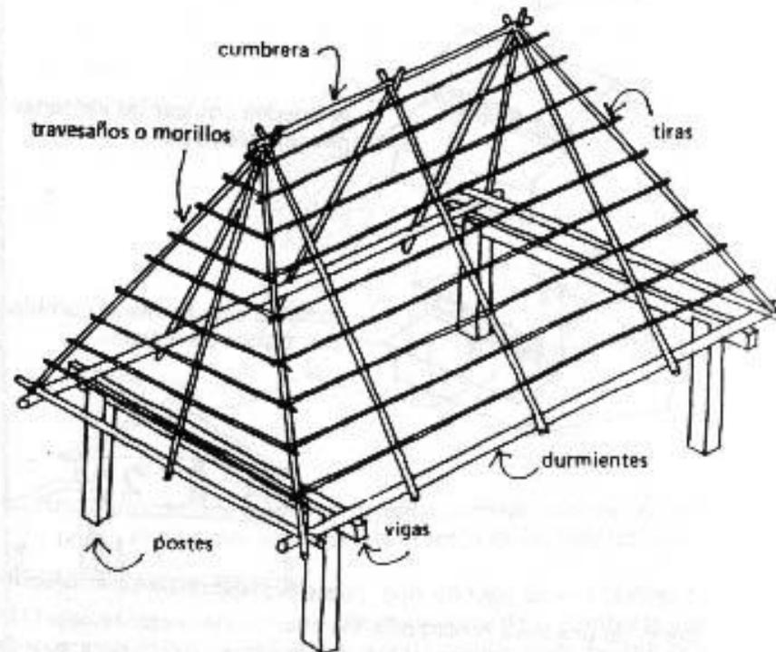
Se pueden hacer variaciones en la posición de los horcones que soporten la estructura del techo con respecto a las paredes:
