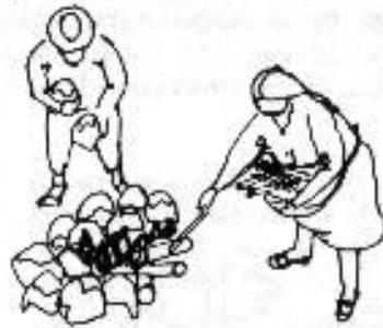
Mezclando agua poco a poco con los terrones se apaga la cal: hay que moverlas constantemente con un rastrillo hasta que se desharaten.
