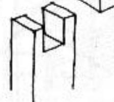
la junta de horcones y viga en madera gruesa
