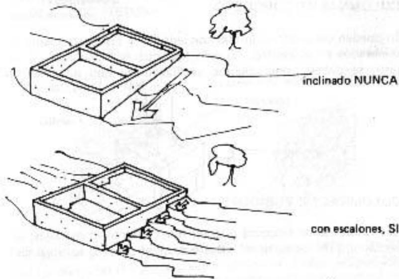
Otra manera puede ser la de seguir el declive con pisos a niveles diferentes, entonces los cimientos y los pisos quedan en varios niveles del terreno:
