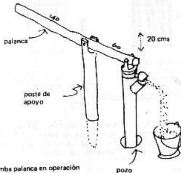
La palanca y el poste de apoyo se hace de madera. La palanca es de 2 metros. Para bombear agua se darán golpes cortos para que el tubo no baje y suba más de 20 centímetros.
