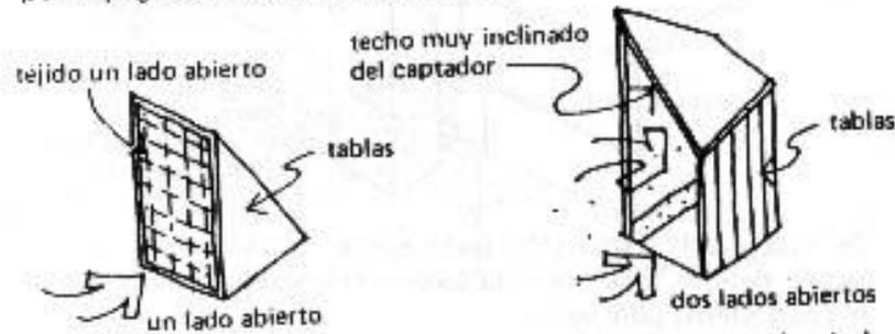
En áreas con poca brisa se hace un captador con dos lados abiertos el techo inclinado para guiar mejor el aire hacia abajo.
