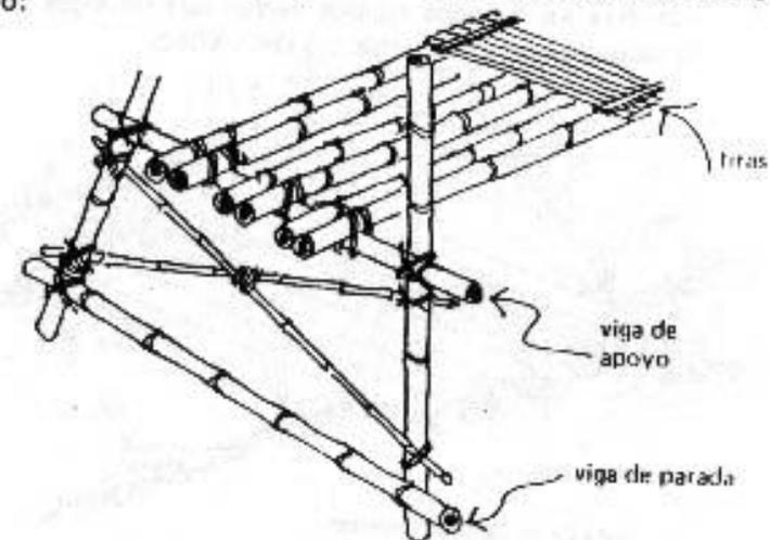
Nota: para más claridad solamente se muestran algunas de las vigas necesarias; tampoco está dibujada la cubierta.
