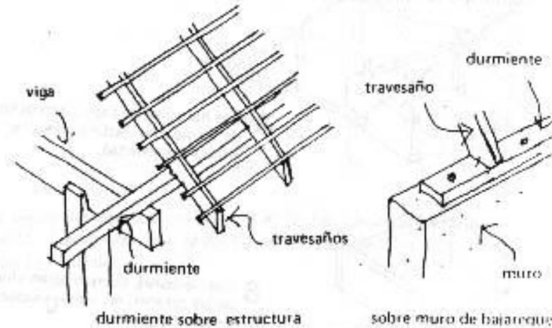
Cuando se construye un techo con doble inclinación, se usan tres durmientes.
