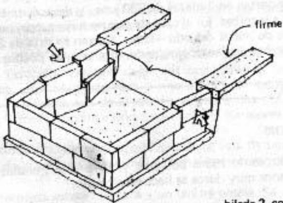
Con los bloques inclinados se forman dos columnas de "dientes" por adentro, que luego sirven para agarrar las placas verticales de separación.
