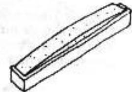
Normalmente la mezcla se encoge y muestra grietas. Se coloca toda la mezcla de un lado y se miden los centímetros que la mezcla ha encogido.
