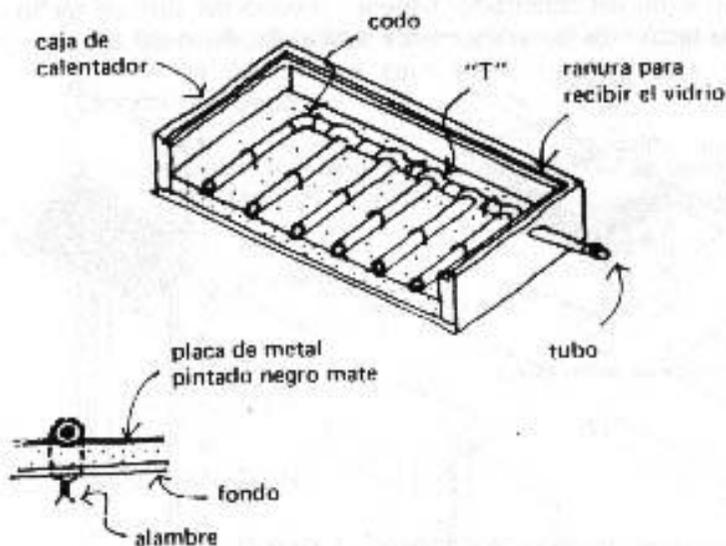
Para mantener los tubos en buen contacto con la placa de metal se hacen agujeros en la placa y el triplay del fondo de la caja. Se pasa un alambre y se amarra bien para que el tubo esté en contacto con la placa. Después se pinta toda la placa y los tubos, de color negro-mate.
