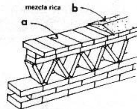
En regiones lluviosas hay que usar para la hilada final un mortero más rico para que el agua no quiebre las juntas (a). Otra solución será dar un acabado de cemento (b).
