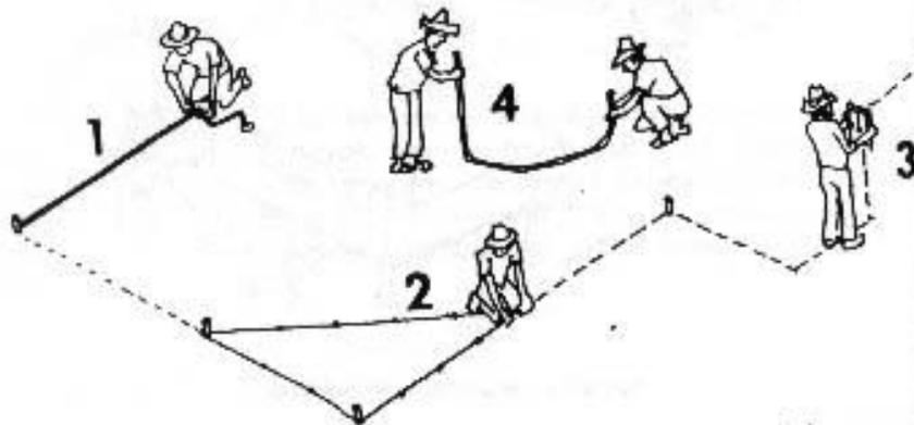
Usando estos instrumentos se puede marcar el trazo de la construcción que indicará los centros de las cepas, en donde se vá a construir los cimientos.
