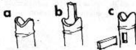
Se usa un perno de madera dura para atar las cuerdas o alambres.
