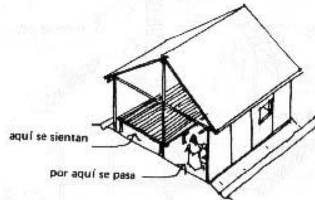
Cuando se construye sobre un terreno inclinado en una colina, hay que hacer una serie de plataformas para formar los pisos.
