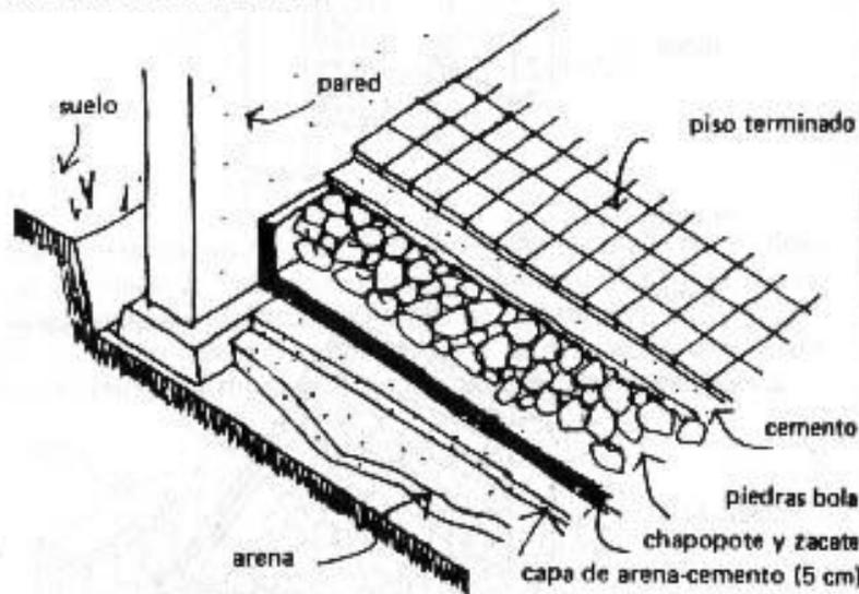
Encima de las piedras se pone una capa de mortero y se le da un acabado con azulejos oscuros o con cemento pintado de cualquier color oscuro.
