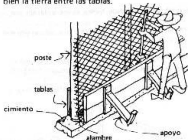
Se colocan las tablas en ambos lados formando un cajón de 30 cm de altura de ancho variable, según el espesor del muro. Las tablas se soportan con puntales inclinados.
