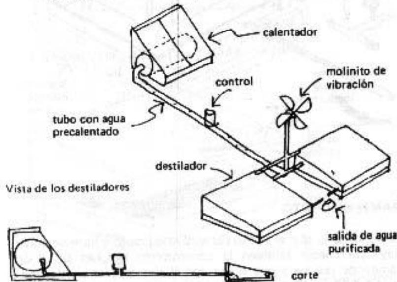
Quando se utiliza agua precalentada hay que construir un control para que el nivel dentro de la charola se mantenga constante. Ver calentador tipo termo-sifón y como hacer un control.
