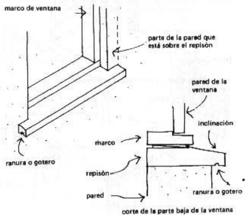
Hay que extender un poco el repisón a los lados para fijarlos con el peso de los tabiques; sino, el repisón se afloja y deteriora con el tiempo.
