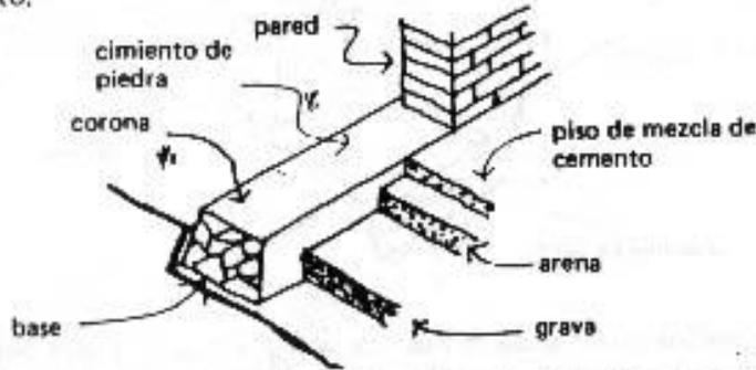
El ancho depende de la resistencia del suelo, si es blando o si es duro. Depende también del peso de los muros y del techo. Una casa hecha con paredes de otate y techo de palapa, necesita un cimiento menos ancho que un cimiento para una casa de tabiques. La corona puede ser menos ancha que la base, formando un talúd.
