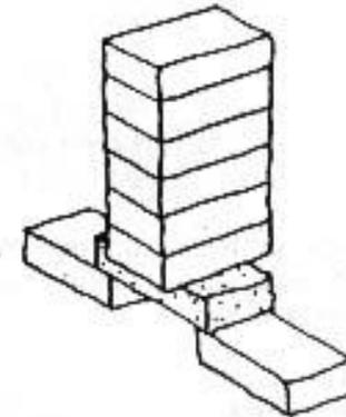
Cuando los adobes no sean muy resistentes se debe cambiar la mezcla o bien, sólo se pueden usar estos adobes para paredes interiores, que no soporten el peso de la estructura del techo.
