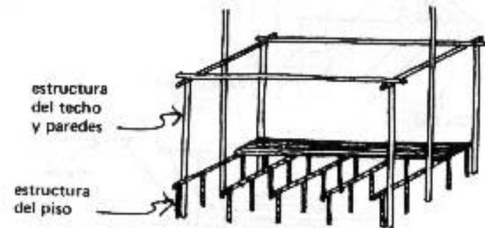
Quando se levanta el piso, hay que darle una estructura de apoyo separada de las paredes y el techo.
