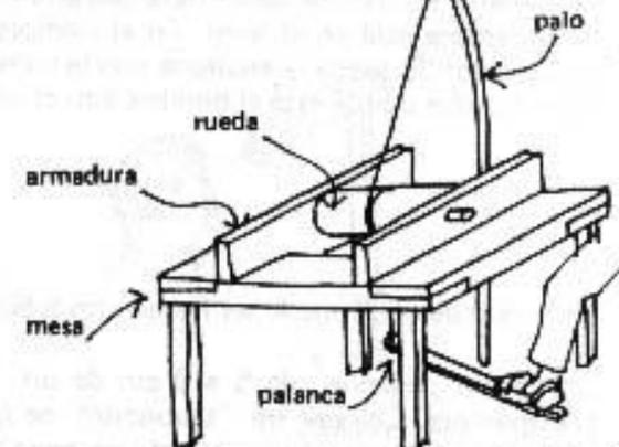
Pisando la palanca, la cuerda baja y empieza a girar el rodillo, la tensión del palo hace que la cuerda regrese dando vueltas al eje.
