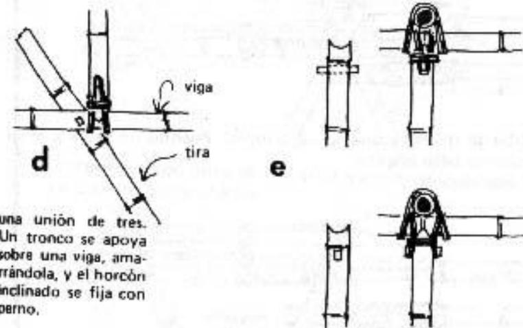
una unión de tres. Un tronco se apoya sobre una viga, amarrándola, y el horcón inclinado se fija con perno.
