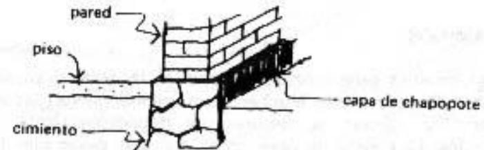
**D** Para parar el paso del agua hay que hacer un recubrimiento en una pared de tierra así:
