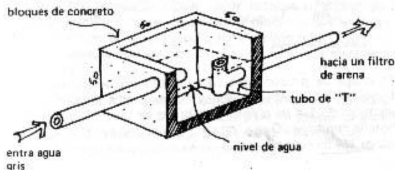
La caja tiene una tapa de concreto o de madera. Hay que abrir la caja de vez en cuando para sacar las natas de las grasas cuando ya haya demasiadas.
