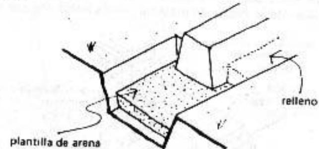
Los espacios encima de la base de arena y entre la cara del cimiento y la cara de la zanja, se puede llenar después con tierra.
