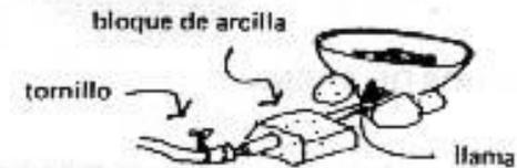
Hay que poner un tornillo mordaza a la manguera para regular la flama. El tubo se pasa por un bloque de arcilla para mantener su posición.
