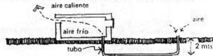
Se debe tapar la entrada para que no entre la lluvia, pero que deja pasar el aire. La salida hacia el cuarto tiene una tela de mosquitero para impedir el paso de insectos. Se le fija con tornillos para poder limpiar de vez en cuando. Sobre la tela de mosquitero se coloca una rejilla para poder controlar la cantidad de aire que entra.
