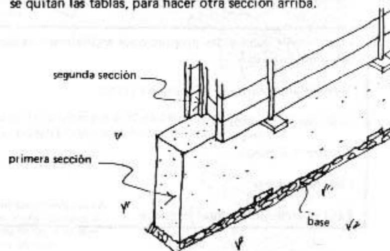
Así se continúa, haciendo por secciones la pared, una encima de la otra, hasta que se tenga la altura deseada.
