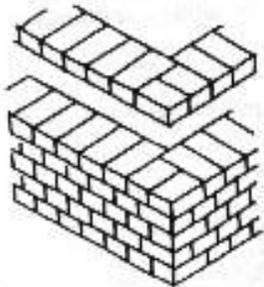
**B** Para las paredes anchas se colocan los tabiques transversalmente. Las esquinas se terminan con dos tabiques a 3/4 del tamaño.
