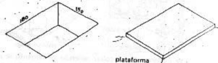
En zonas húmedas hay que construir un piso o plataforma de cemento.
