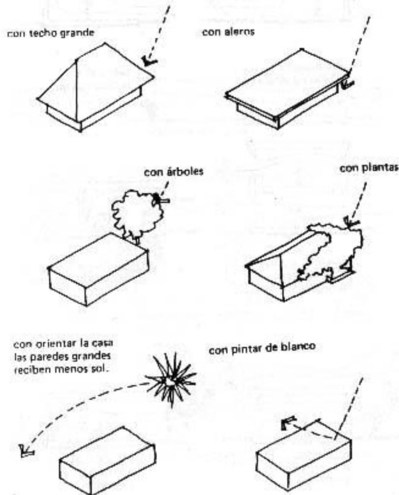
Cuando los rayos del sol pegan en una pared, ésta se calienta de afuera para adentro. Después de algún tiempo, el calor empieza a penetrar el espacio interior de la casa y la temperatura adentro sube.
