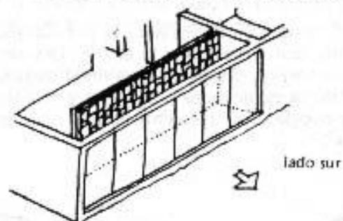
Otra forma semejante sería colocando un marco cubierto con latas atrás de una ventana grande. De noche se cerrará la ventana con un panel de madera por fuera, para que el calor pase para adentro (durante el verano se usa la ventana sin el marco de latas).
