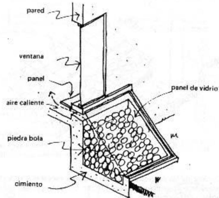
Se llena la caja con piedra bola, del tamaño de un puño. Hay que colocarlas medio separadas para que el aire pueda circular entre ellas. El aire más frío de los cuartos, entra en el calentador a través de tubos enterrados en el piso.
