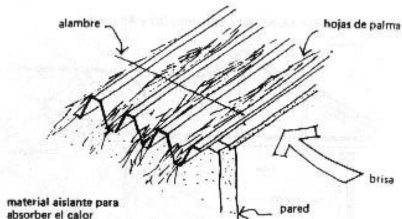
En zonas con muchas lluvias donde se usan aleros grandes para proteger las paredes hay que sacar las vigas para apoyar las láminas. Cuando se dejan las láminas sobresalir de las paredes sin apoyos, las láminas se rompen con el viento.
