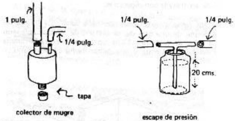
El escape de presión sirve para impedir explosión, se le construye con una botella de unos 20 cms. de alto. Adentro se pone un tubo de 1/4 de pulgada, en forma de letra "T". Se llena la botella con unos 20 cms. de agua y se conecta a las dos mangueras de 1/4 de pulgada.
