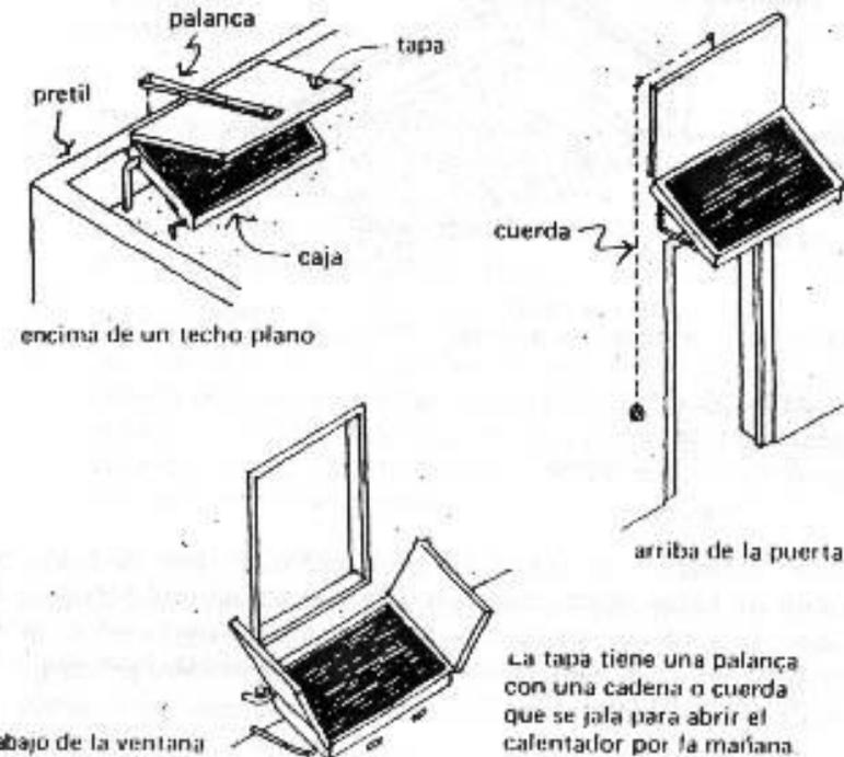
La tapa tiene una palanca con una cadena o cuerda que se jala para abrir el calentador por la mañana.
