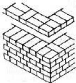
**C** En acabado aparente se alternan las hiladas para hacer un dibujo diferente.
