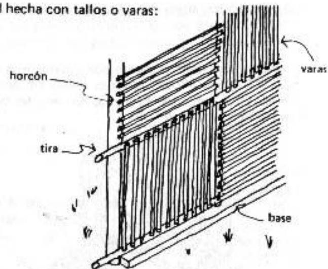
Los tallos de hojas de palma se fijan con clavos o bejuco a una armadura de ramas o madera.
