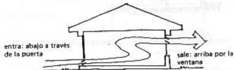
Un ejemplo de ventilación cruzada usando rejillas.
