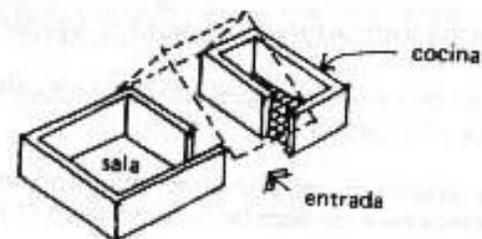
En el tercer ejemplo se continúa el techo para tener un área protegida de la lluvia para comer, entre la sala y la cocina.
