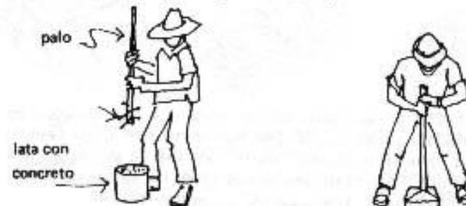
A pesar de que muchas veces la gente simplemente entierra los horcones y construye las paredes de madera o tierra directamente encima del suelo, es mejor separar la estructura del techo y de las paredes del suelo, haciendo un cimiento para disminuir el problema de debilitamiento de los materiales, causado por hundimientos o humedad del suelo.
