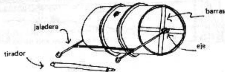
Se puede colocar una pieza de madera para facilitar el movimiento, cuando es hecho a mano. O se puede colocar un animal para jalar el compactador.
