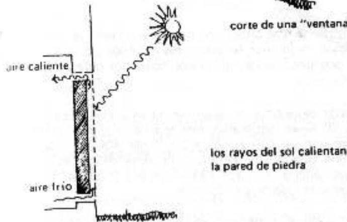
El aire entre la pared y el vidrio se calienta y sube entrando al cuarto. Ahí poco a poco se enfría vuelve a bajar para después regresar de nuevo entre la pared y el vidrio.
