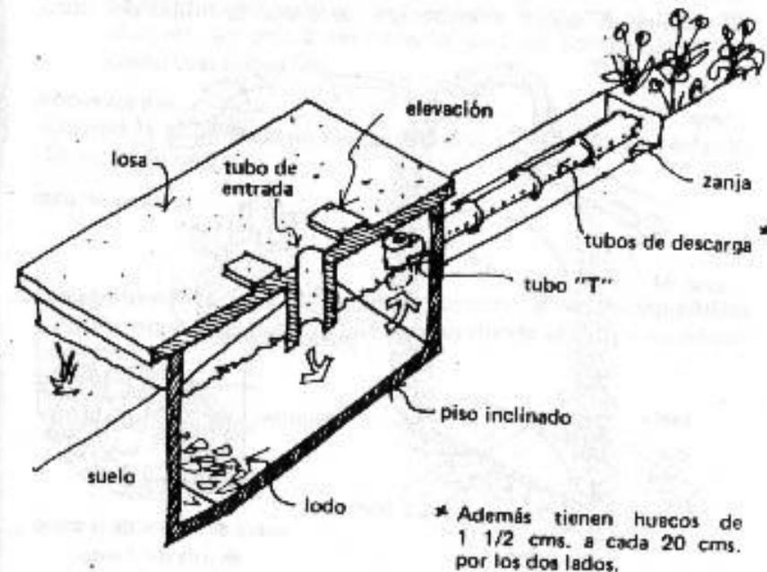
Los tubos de descarga de 5 hasta 10 cms., se conectan al tanque con una "T" para que no pasen sólidos de la letrina.
