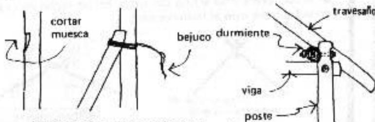
Una junta del poste con el apoyo
