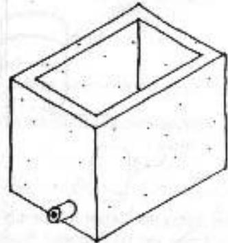
La superficie de las capas finales de adentro se deben pulir con una mezcla muy rica en cemento.
