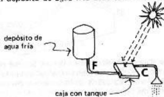
Este tipo de calentador no necesita válvula de presión porque cuando se calienta se aumenta la presión, ésta empujará el agua fría del depósito.
