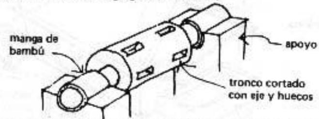
El eje está hecho de un tronco grueso con huecos para conectar los soportes. Los extremos entran en unas piezas de bambú como si fueran baleros. Estos pedazos de bambú se apoyan en unos postes que tienen cortes para que ahí gire sin salirse.
