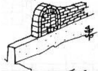
**2** Colocar un arco de ladrillos con mortero y continuar las otras hiladas de la pared.
