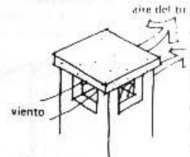
La salida del tiro se cubre con una tapa o "techito" para que el viento pase mejor por las aberturas de abajo las cuales pueden estar a dos lados opuestos, o por todos los lados, como en el dibujo de arriba.
