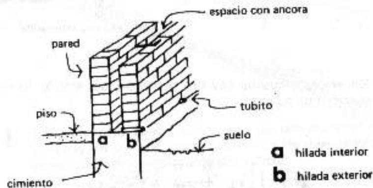
Ahora la humedad no podrá penetrar en la hilada interior, el agua que pase escurrirá por el espacio. En el fondo abajo, se coloca a cada dos metros de distancia un tubito para que el agua pueda correr por afuera del edificio. Con esto el ambiente interior mejorará mucho.
