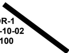
Una sola barra diagonal dibujada al ingresar a una estructura o área indica que las operaciones de búsqueda están desarrollándose en ese momento. Al ingresar a un edificio o un ala separada de un edificio grande, agregue la identificación del Equipo de Búsqueda, la fecha y la hora (24 horas) de ingreso (cerca de la entrada principal).
