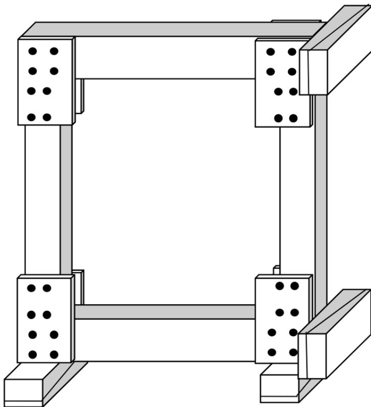
**Carga de Diseño: Cabezal de 4x4 = 2,000 lb (900 kg)**
