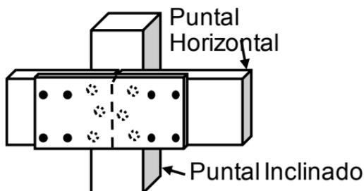
5. Arriostramiento Horizontal Intermedio: (si el puntal inclinado tiene una riostra de punto intermedio).
