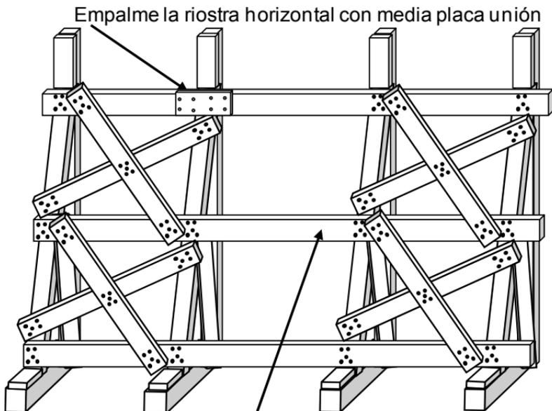
Solo necesita la riostra horizontal del medio si el puntal inclinado tiene una riostra intermedia
