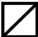
Riesgo Medio para Operaciones de Búsqueda y Rescate Urbano donde la estructura está significativamente dañada. Tal vez necesitaría apuntalamiento, arriostamiento, remoción y/o control de peligros. La estructura puede estar derrumbada parcialmente.
