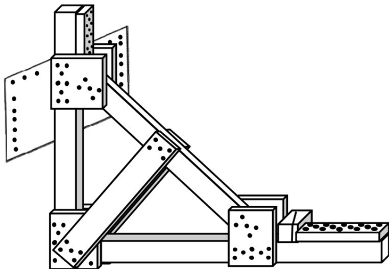
**Arriostamiento de puntal inclinado: se usa como soporte de paredes de concreto o mampostería muy agrietadas.**
