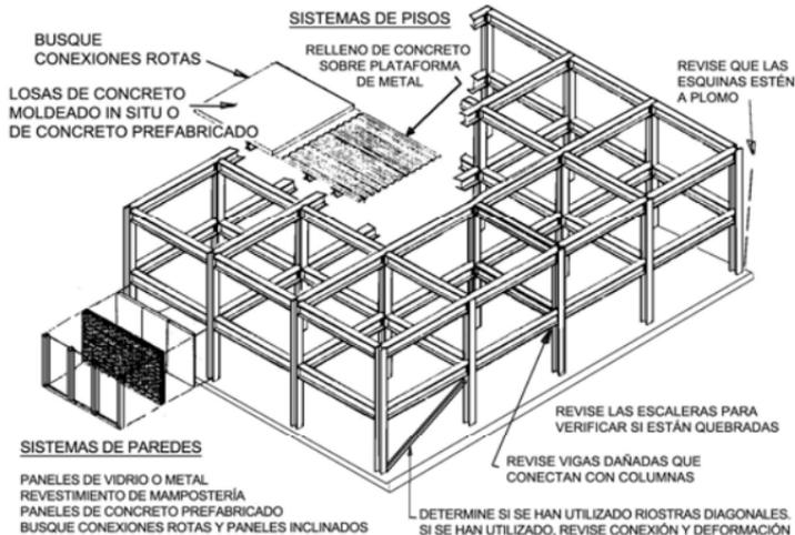
YA QUE HAY MUCHAS PARTES Y CONEXIONES OCULTAS, LAS MEJORES SEÑALES DE FALLA SON EL EXCESO DE MOVIMIENTO QUE CAUSA DAÑOS EN ELEMENTOS NO ESTRUCTURALES Y LAS ESTRUCTURAS QUE NO ESTÁN A PLOMO
