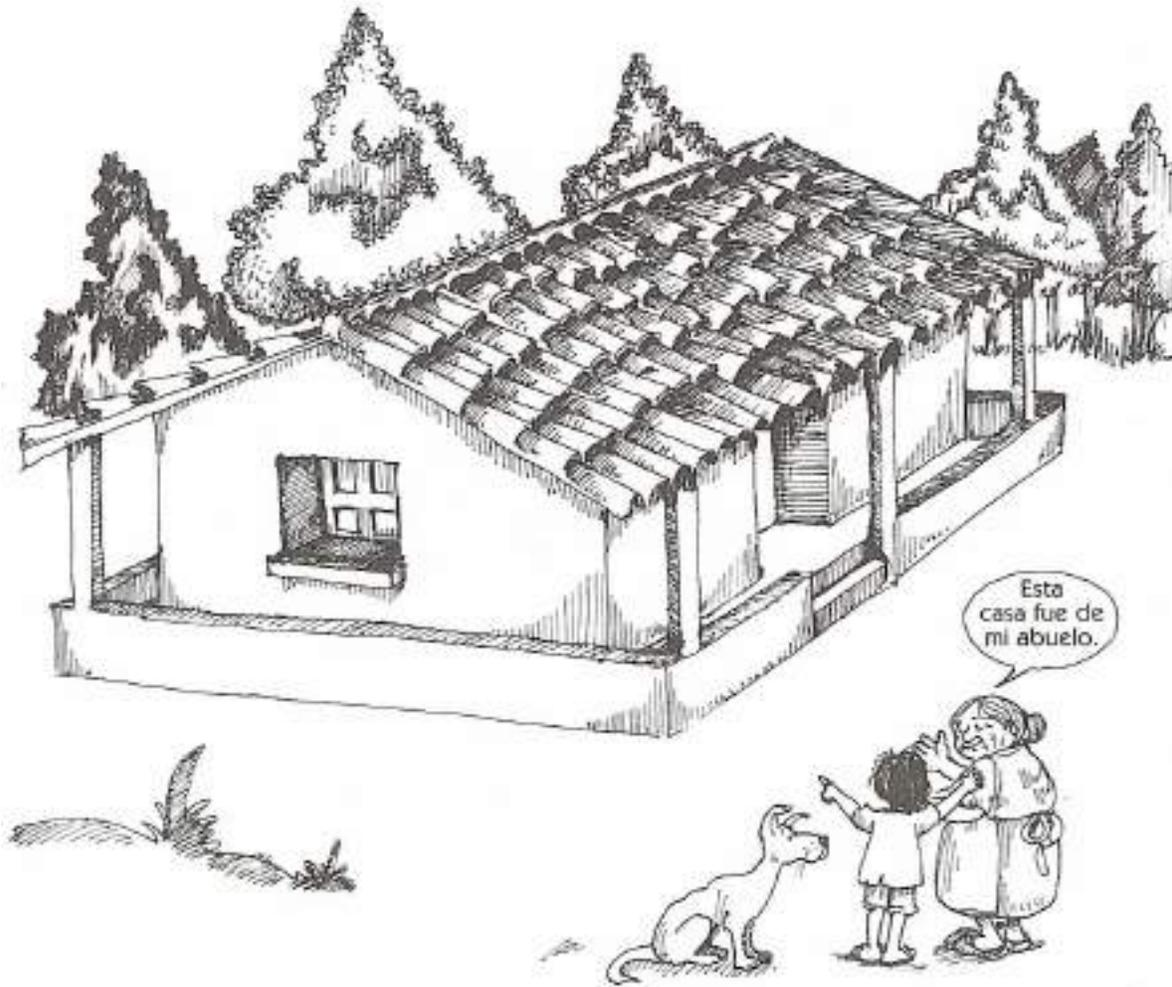
**A**demás, como el agua le hace mucho daño al adobe, construían las casas con amplios corredores por los cuatro costados, para evitar que la lluvia azotara en las paredes. Son casas muy antiguas que resistieron muchos terremotos.
