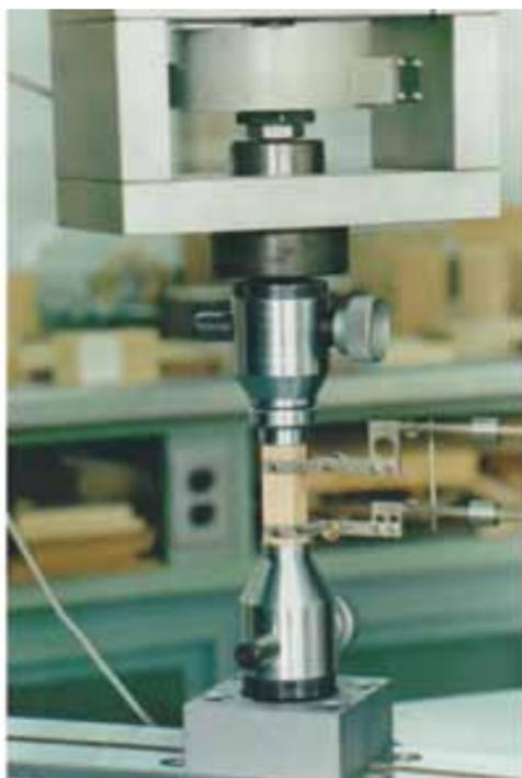
Figura 5. Ensayo de compresión
