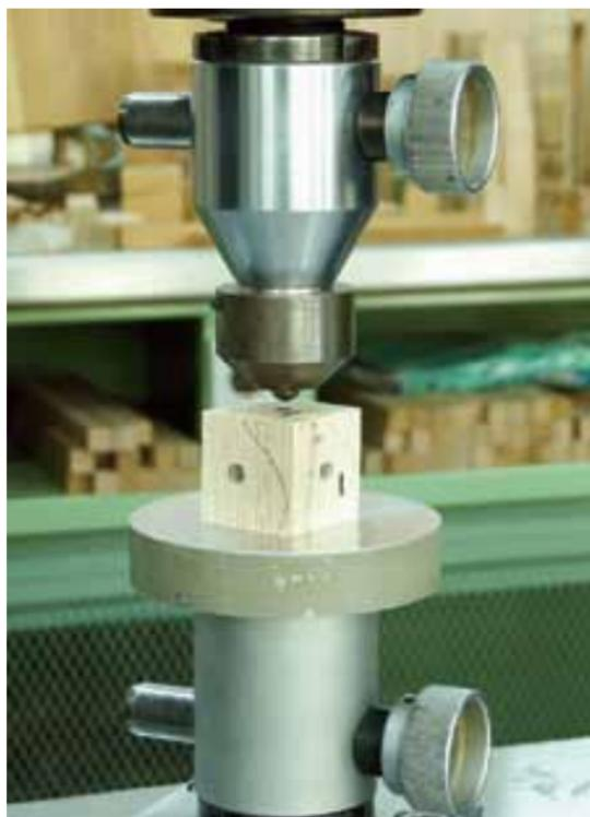
Figura 9. Ensayo de dureza BRINELL
