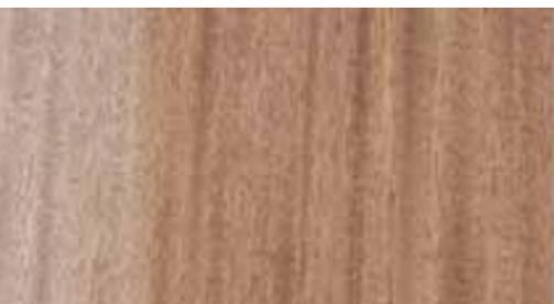
Figura 1a. Listones alternantes de color claro y oscuro causado por diferente reflexión de la luz incidente, por ejemplo en Sapeli (*Entandrophragma cylindricum*)
