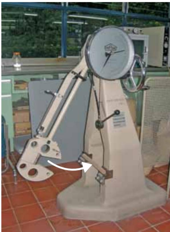
Figura 7. Ensayo resistencia al impacto (péndulo)
