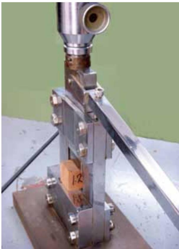
Figura 8. Ensayo de cizallamiento (corte)
