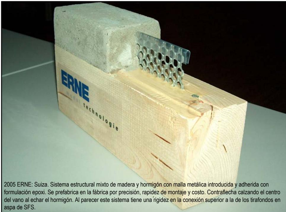
2005 ERNE: Suiza. Sistema estructural mixto de madera y hormigón con malla metálica introducida y adherida con formulación epoxi. Se prefabrica en la fábrica por precisión, rapidez de montaje y costo. Contraflecha calzando el centro del vano al echar el hormigón. Al parecer este sistema tiene una rigidez en la conexión superior a la de los tirafondos en aspa de SFS.
