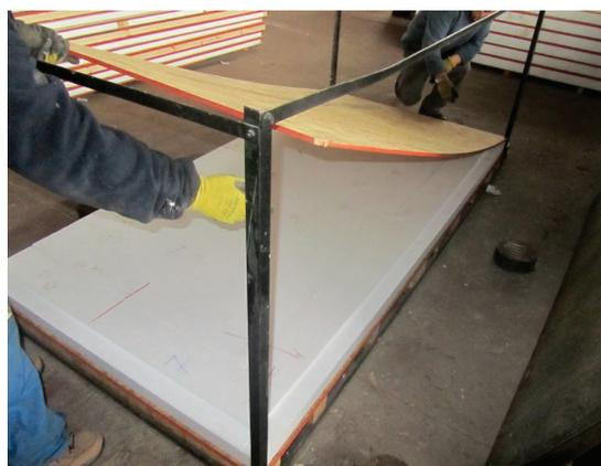
Figura 7b Ordenamiento en Jaula de armado
