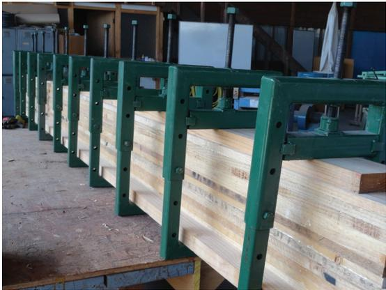
**Figura 8c** Preparación de Vigas laminadas
