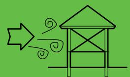
2- La continuidad de los pilares principales hasta nivel de plato evita desplazamientos
